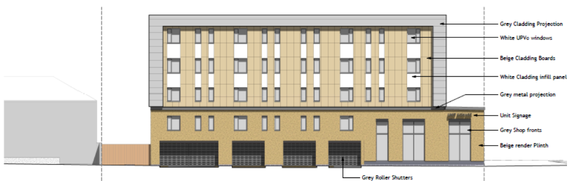
Side Elevation (Buttrills Road)
